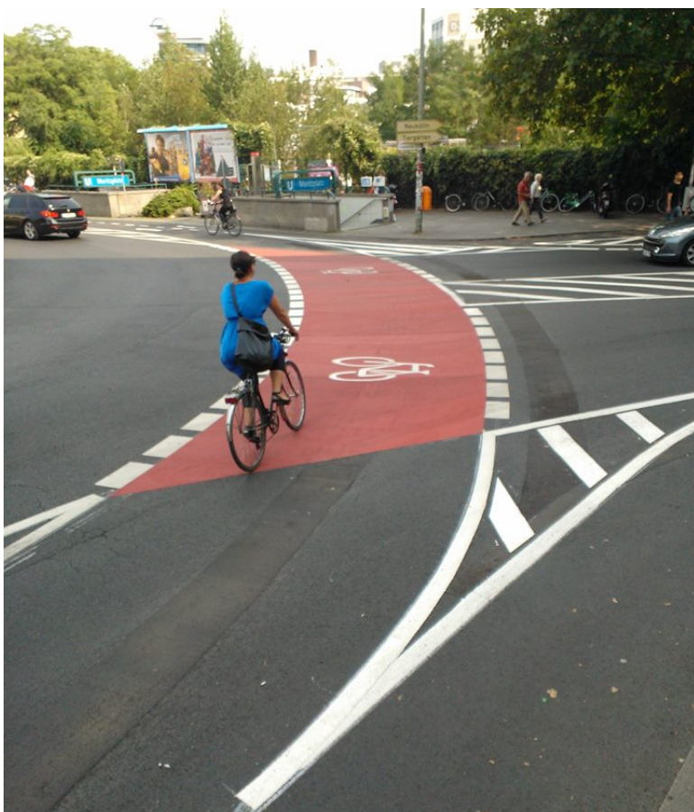
Foto 41: Faixas para tráfego de bicicleta em rotatória, Berlim 2016.
